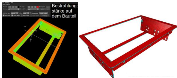
Abb. 4 Bestrahlungsstärke-Verteilung aus der Optik-Simulation (links) und vernetztes Thermalmodell (rechts).
