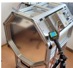
Abb. 1 Oktagonaler Prototyp-Infrarotofen mit der zur Temperaturmessung verwendeten Wärmebildkamera. [5]
