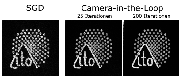
Abb. 2 Verlauf der Kalibrierung: Kameraaufnahmen nach dem SGD (links), nach 25 (Mitte) bzw. 200 (rechts) Iterationen der CITL-Kalibrierung.
