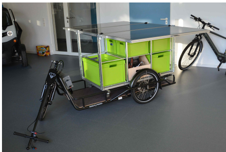
Fig. 4 Funktionsprototyp, montiert auf einem Fahrradanhänger mit Eigenantrieb.
